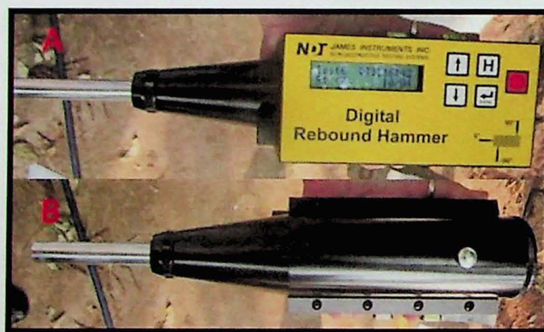
Figura 6-1 – Martelo de Schimidt. Em “A” painel digital do martelo e em “B” corpo do martelo.
