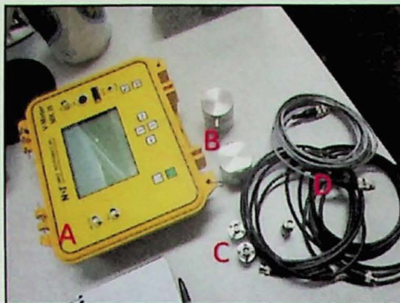
Figura 6-2 – Equipamento para realização de ensaios de determinação da velocidade de propagação de ondas ultrassônicas. Na figura pode-se identificar: (A) Unidade de Ultrassom; (B) Transdutores de 54 kHz; (C) Transdutores de 150 kHz; e (D) Cabos coaxiais.
