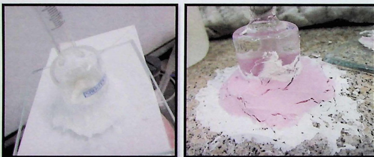
Figura 7-6 – Tubo de Karsten fixado com Massa de Modelar (esq.) e Alginato (dir.).
